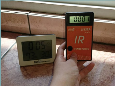
IR值(施工後) IR Value (After application): 1 環境溫度 Ambient temp: 30.0°C
