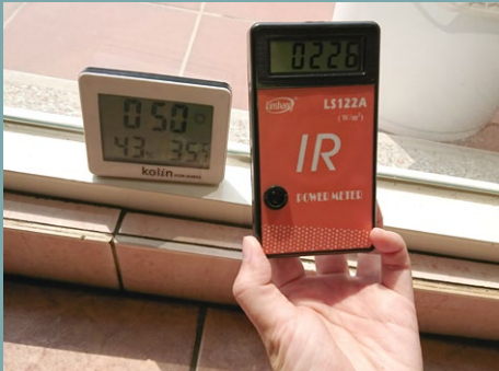
IR值(施工前) IR Value (Before application): 226 環境溫度 Ambient temp: 35.0°C
