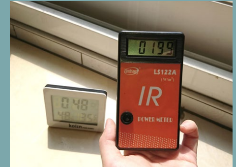
IR值(施工前) IR Value (Before application): 199 環境溫度 Ambient temp: 35.0°C
