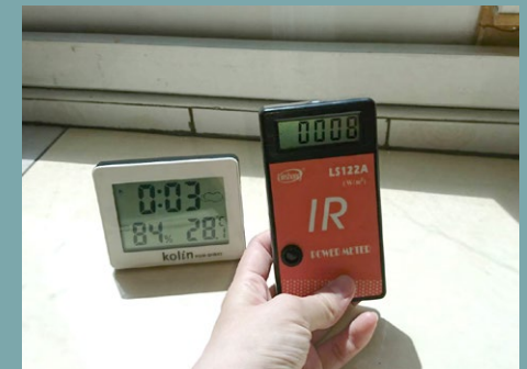
IR值(施工後) IR Value (After application): 8 環境溫度 Ambient temp: 28.1°C
